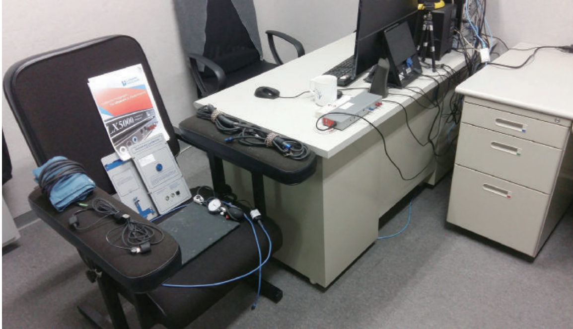
圖三：測謊室配置圖，圖中包括測謊椅、校正設備與電腦式測謊儀。
